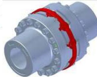
O porta elementos é flangeado ao cubo. Esta forma permite o desacoplamento das máquinas, através da extração do conjunto porta elementos, sem a necessidade de deslocamento de qualquer uma delas.
